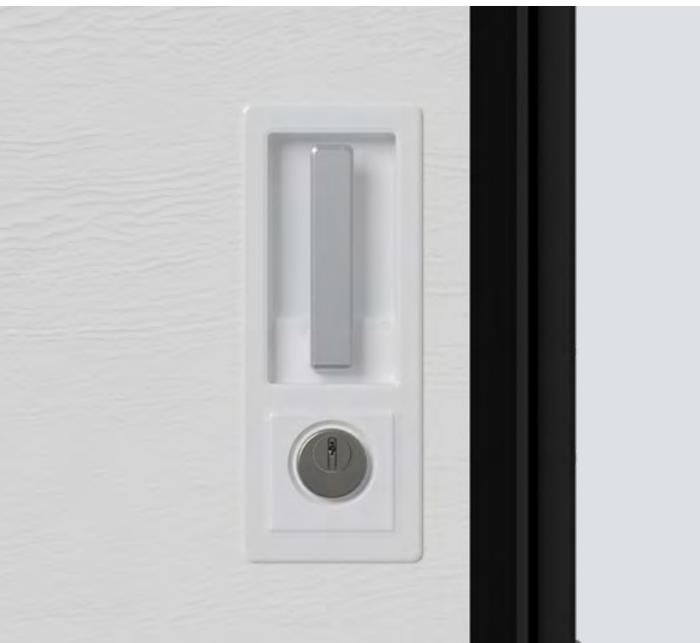
**VERRIEGELT.** Der elegante Torgriff mit vertiefter Griffmulde lässt sich von innen und außen leicht bedienen. Beim Schließen rasten drei Haken an der Kurvenseite und drei Sicherheitsbolzen an der Schließseite des Torblatts ein und verbinden das Torblatt fest mit der Seitenzarge. Bei handbetätigten Toren verriegelt ein Hakenfallenschloss zusätzlich die Schließseite.
