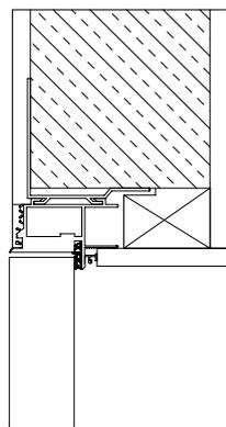
Horizontalschnitt mit stumpf einschlagender Tür
