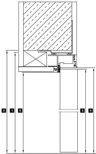
Horizontalschnitt mit stumpfem Türblatt
